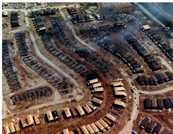
Fig. 10: Esempio di mancanza di robustezza. Il fuoco si è propagato a domino per mancanza di cesse tagliafuoco. Il disastro è sponsorizzato alla causa iniziale.
