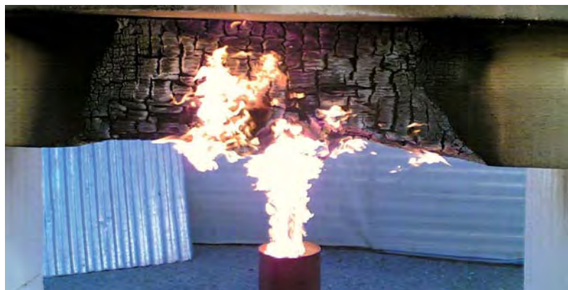
Fig. 7: La sperimentazione eseguita su diverse specie legnose ha messo chiaramente in luce come ci sia un'ottima correlazione fra massa specifica e velocità di penetrazione della carbonizzazione.
