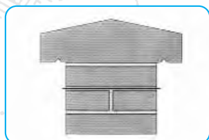
Nelle copertine realizzate con elementi di grandi dimensioni conviene mettere in opera, sotto ogni giunto, un accorgimento come quello illustrato qui a fianco, che può essere compreso nello strato di allettamento della copertina stessa.
