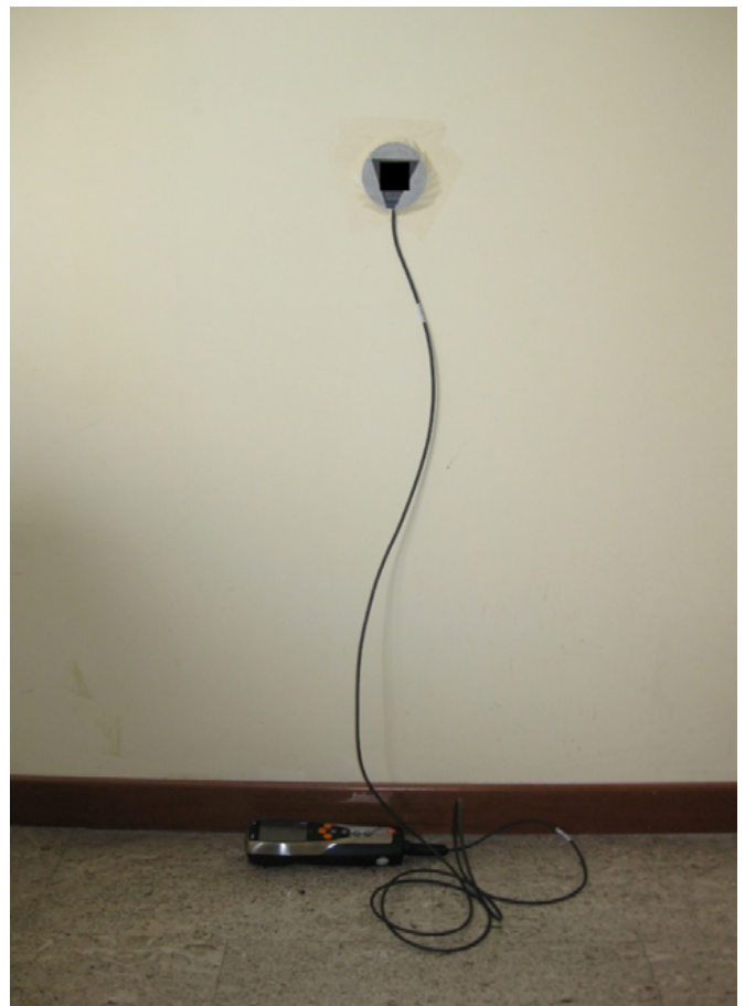
Collocazione di un termoflussimetro e della piastra termoflussimetrica
